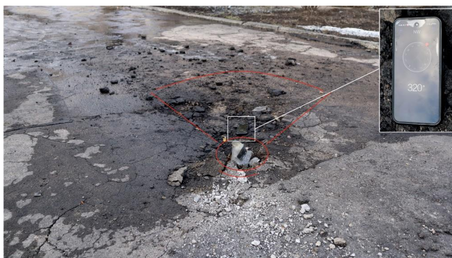
Рис. 59 – Определение направления обстрела методом осколочных канавок на месте попадания № 22.
