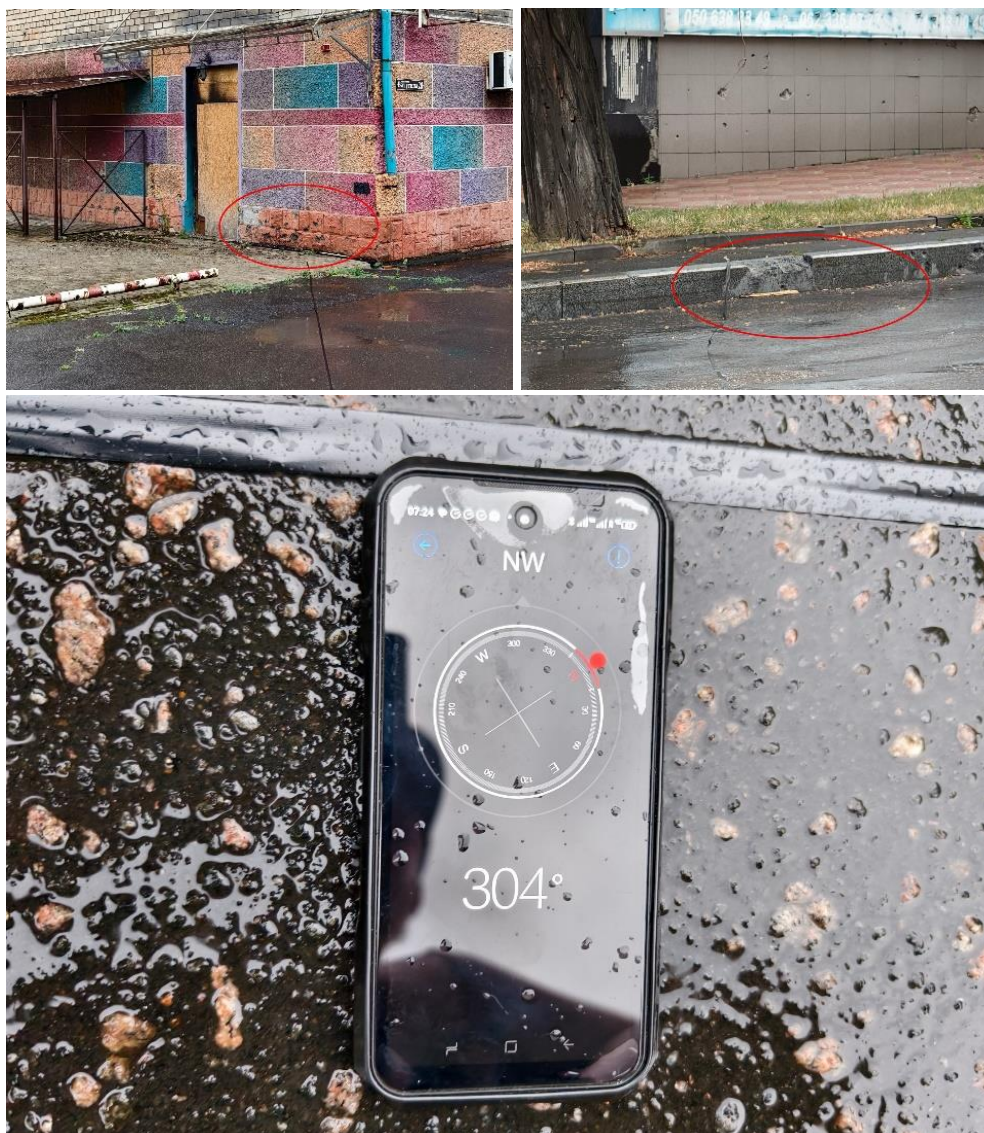
Рис. 26 – Исследование попадания №5 на предмет направления, с которого осуществлялся обстрел.
