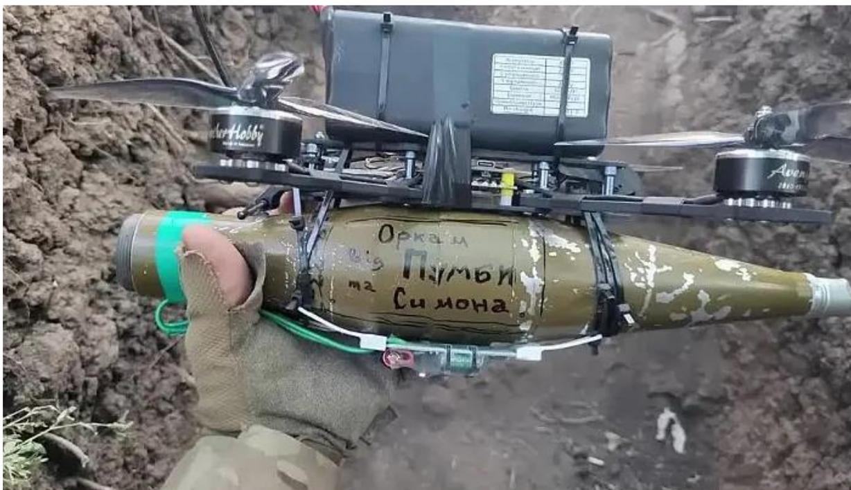
*Рис. 4 – Украинский FPV-БПЛА-камикадзе с присоединённым зарядом от РПГ<sup>13</sup>.*
