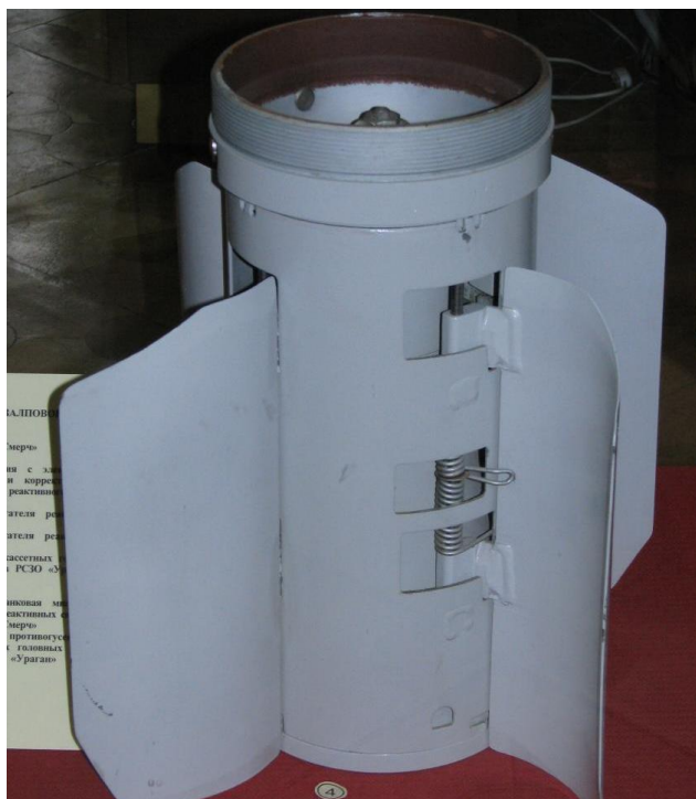
Рис. 15 – Макет блока стабилизатора снаряда РСЗО «Ураган» 19
