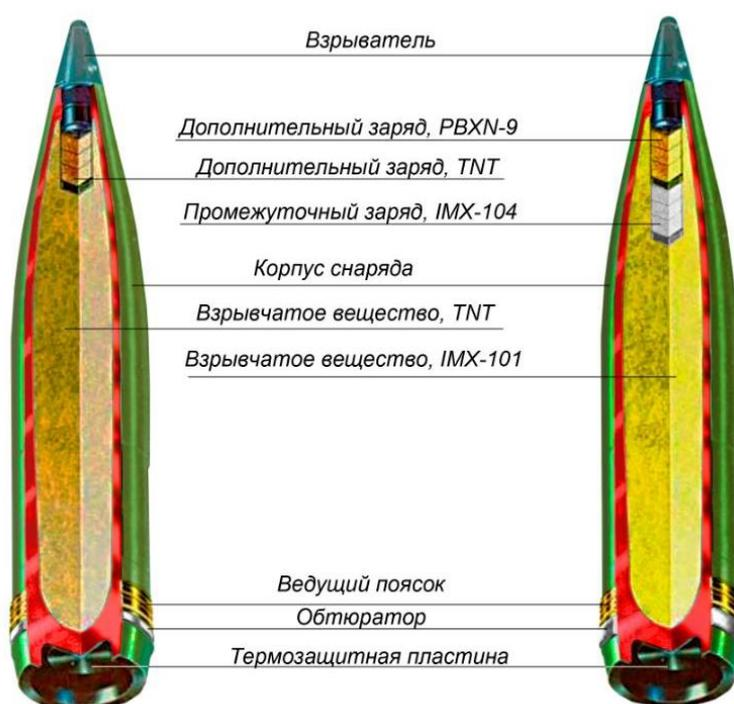
Рис. 9 – Снаряд М795 в разрезе. Слева: ВВ - тротил; справа: ВВ - IMX-101<sup>21</sup>.
