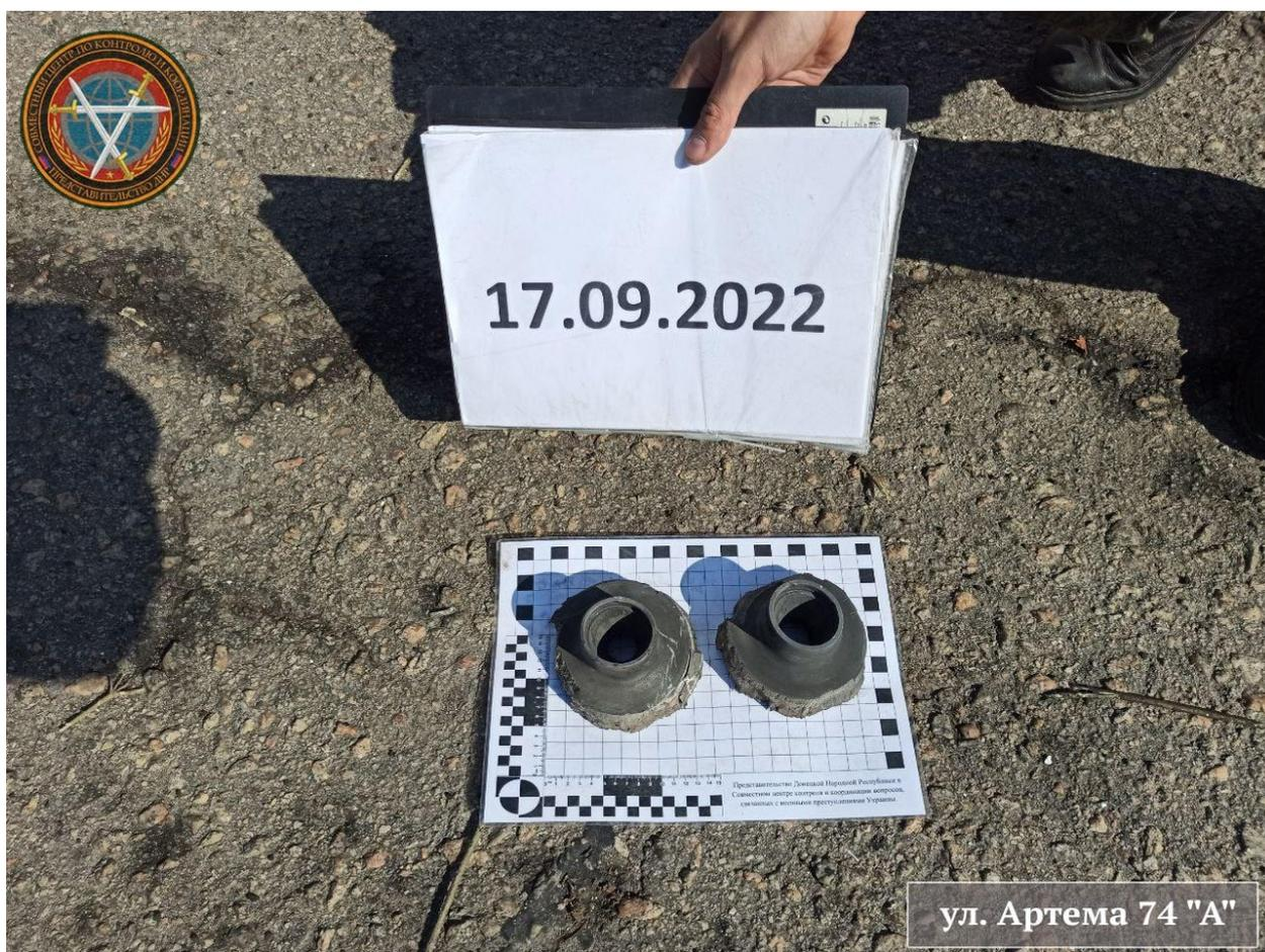
*Рис. 13 – Сопла активно-реактивного снаряда М549 образца НАТО, обнаруженные сотрудниками СЦКК.*
