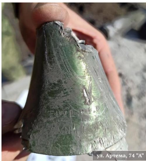
*Рис. 15 – Взрыватель PD.M739A1 образца НАТО, обнаруженный сотрудниками СЦКК.*
