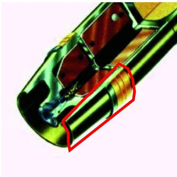
Рис. 11 – Донная часть активно-реактивного снаряда M549/M549A1 (красным выделена часть как правило обнаруживаемая в виде крупных осколков на месте взрыва).
