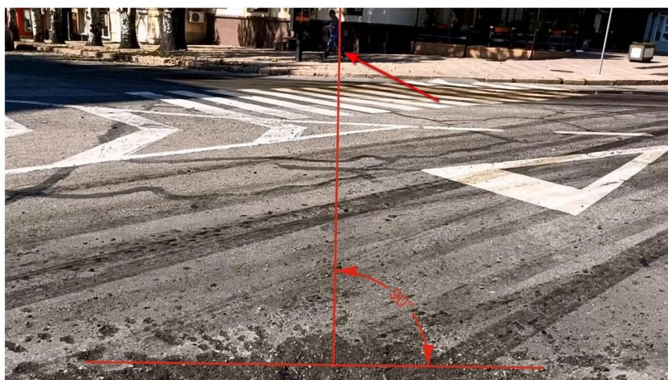
*Рис. 22 – Определение местоположения точки пересечения азимута, вдоль которого происходило движение снаряда, со стеной здания по адресу бул. Пушкина, д. 16.*
