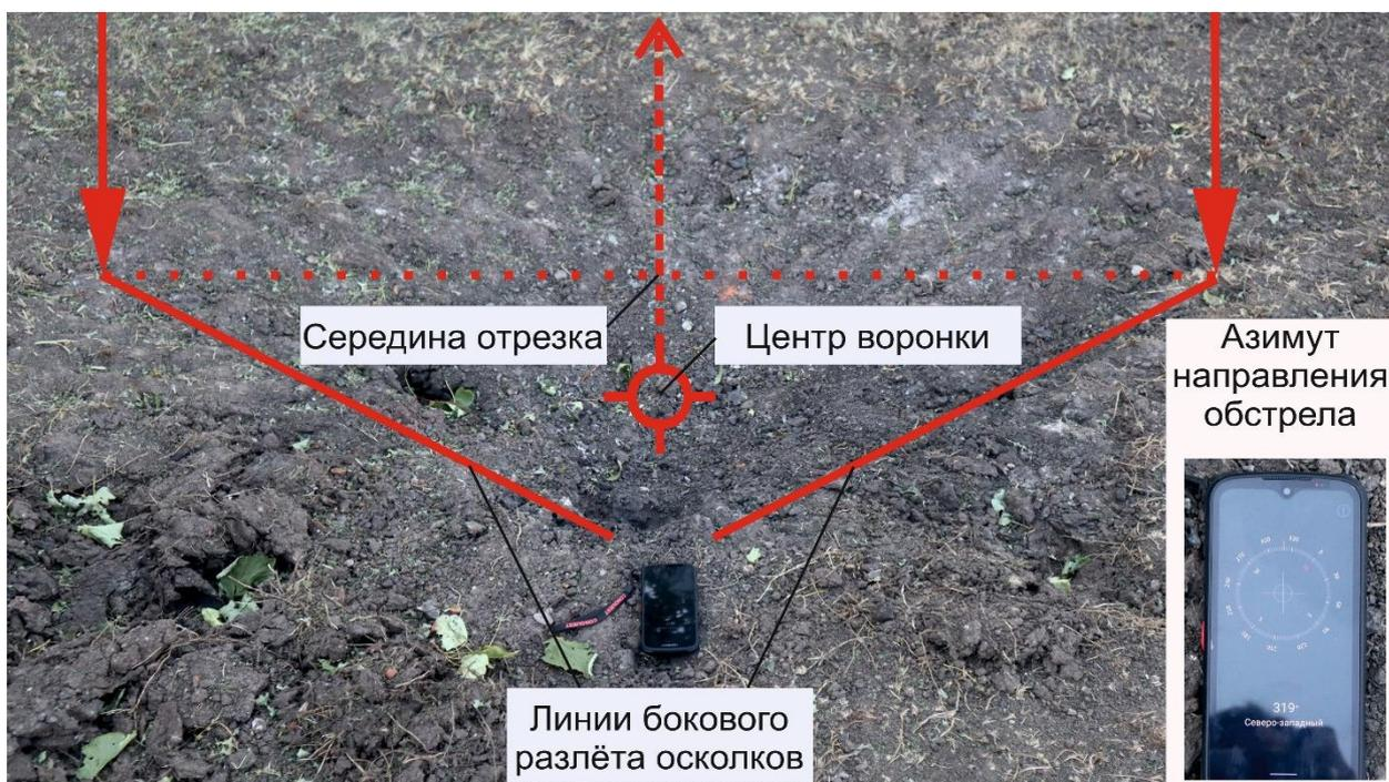
Рис. 23 – Определение направления обстрела на примере попадания № 3.
