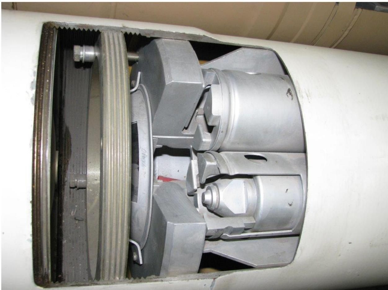
Рис. 26 – Снаряд РСЗО «Смерч» с кассетной боевой частью в разрезе<sup>23</sup>.
