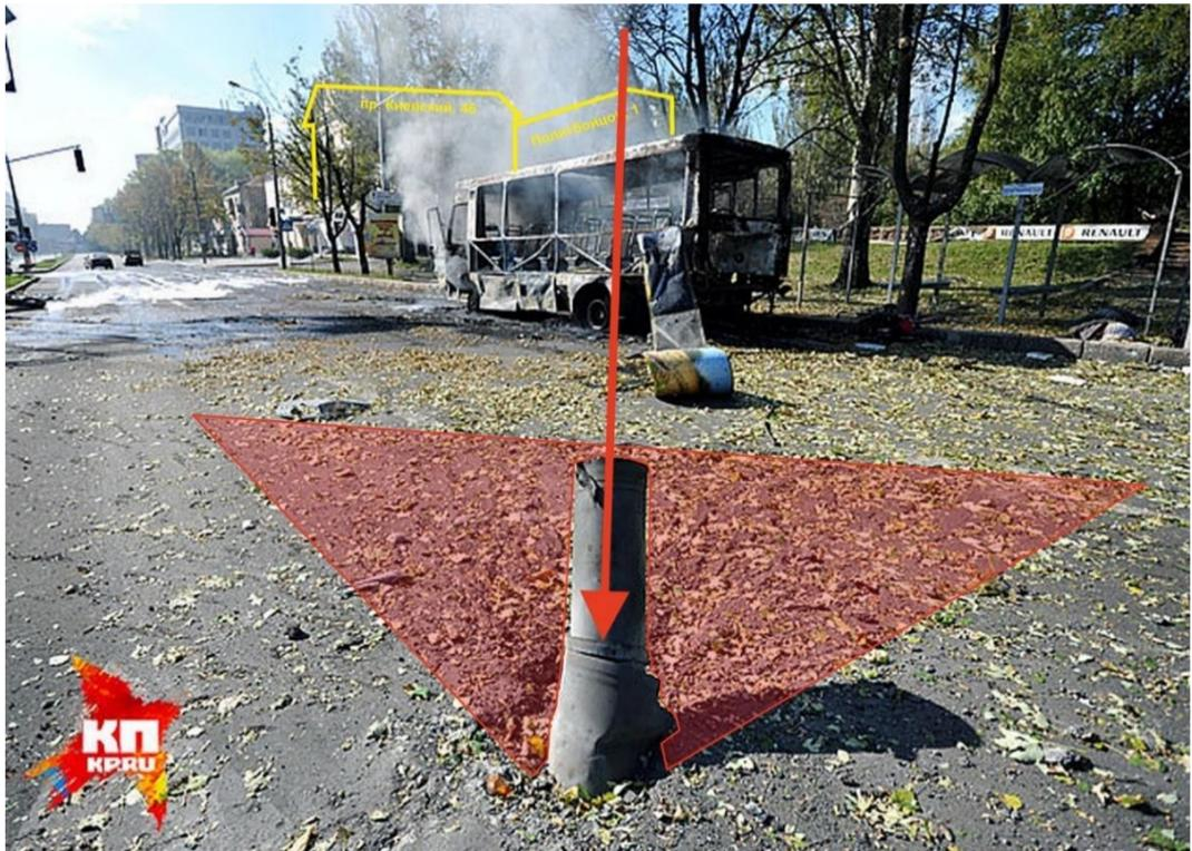
*Рис. 9 – Определение направления обстрела по физическим следам на местности.*
