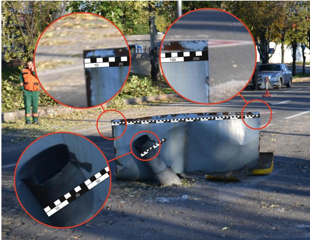
Рис. 4 – Определение калибра снаряда при помощи масштабной линейки<sup>25</sup>.
