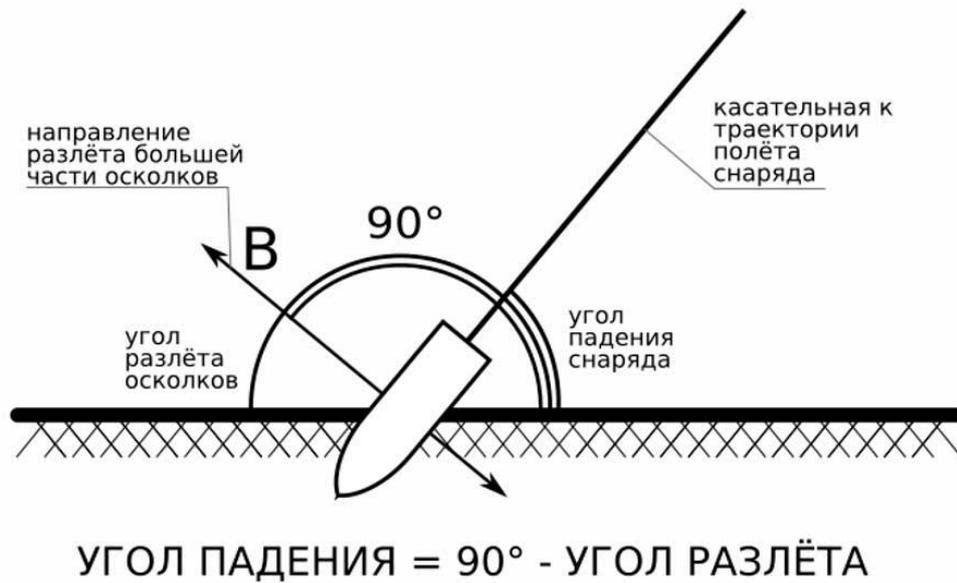
Рис. 22 – Определение угла падения снаряда.
