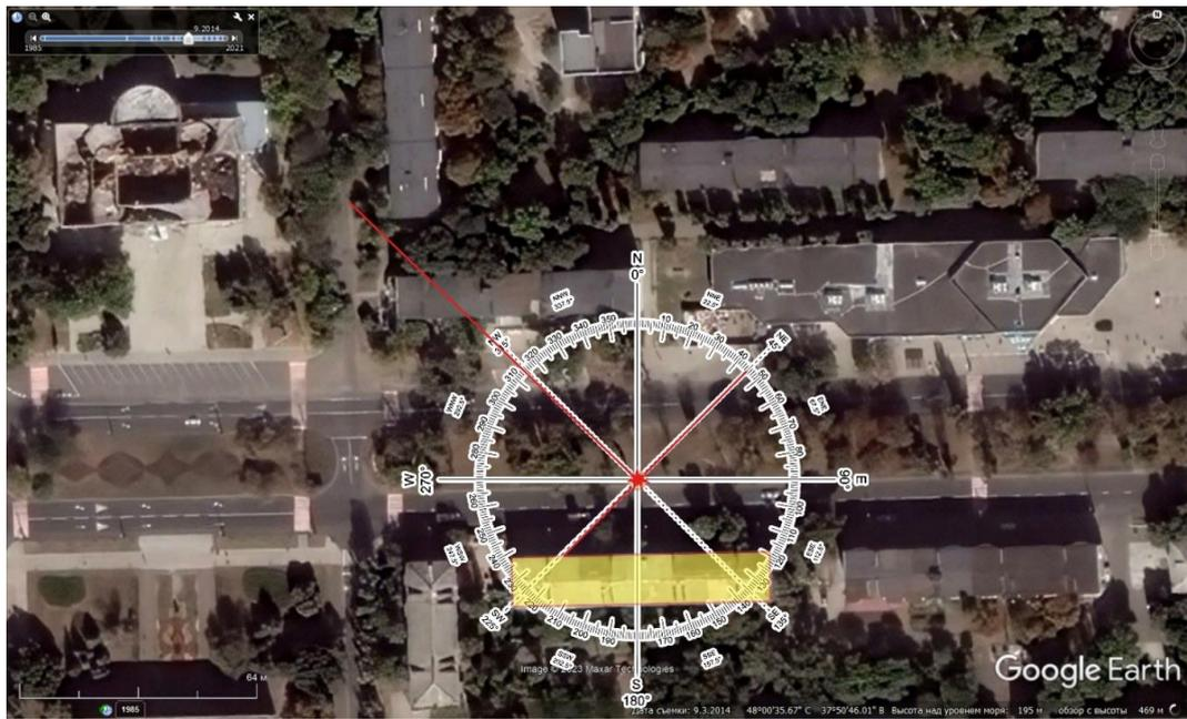
*Рис. 31 – Определение направления, с которого осуществлялся обстрел, по попаданию № 6.*
