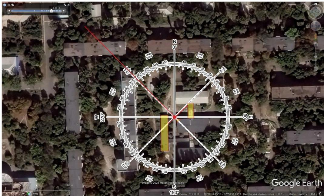
Рис. 29 – Определение направления, с которого осуществлялся обстрел, по попаданию № 2.
